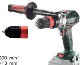
Leerlaufdrehzahl 1./2. Gang 0-550/0-2000 min-1 Bohr-Ø Holz/Stahl 68/13 mm Max. Gewinde-Ø M12 mm Drehmoment weich/hart 65/130 Nm Bohrfutterspannbereich 1,5-13 mm 1,8 kg Gewicht ohne Akku
