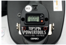
Digitalanzeige mit aktueller Hebekraft
