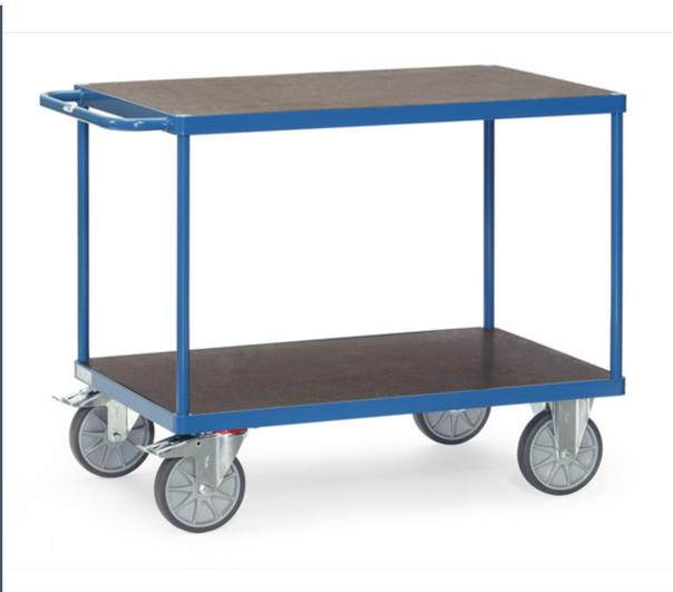
Stahlrohr und Profilstahl geschweißt, pulverbeschichtet RAL 5007. 2 Plattformen mit rutschsicherer Siebdruckplatte aus wasserfestem Sperrholz. 2 Lenk- und 2 Bockrollen, TPE-Bereifung, Naben mit Rillenkugellager. Feststeller an den Lenkrollen, gemäß der Europäischen Norm EN 1757-3 (Sicherheit von Plattformwagen). Tragkraft obere Ladefläche 200 kg.
