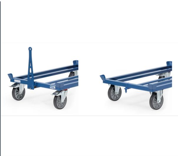
Für den Transport mit Zugfahrzeugen bis 6 km/h. Züge bis 5 Fahrgestelle möglich. Maximales Zuggewicht 2.000 kg. Deichsel aus Flachstahl, stellt sich mittels Gasdruckfedern selbsttätig in senkrechte Ruheposition. An der Bockrollenseite befindet sich ein stabiler profilierter Kupplungsbolzen. Verbindung durch Fußbetätigung möglich.
