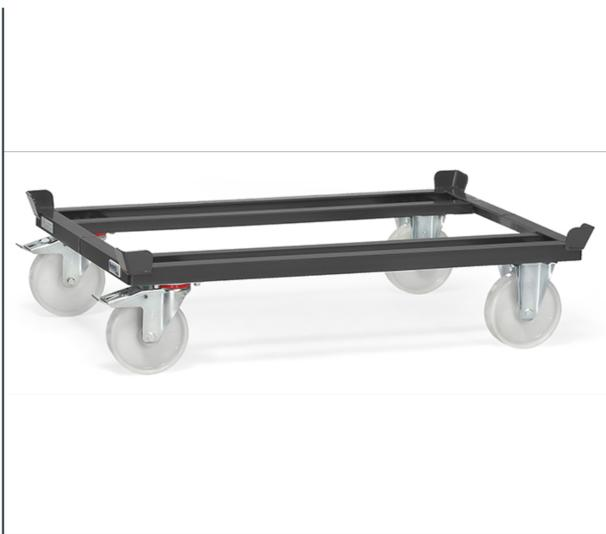
Für Flachpaletten und Gitterboxen. Robuste Winkelstahl-Schweißkonstruktion, mit 4 Fangecken, pulverbeschichtet, anthrazitgrau RAL 7016. 2 Lenk- und 2 Bockrollen, Polyamid-Räder, Naben mit Rollenlager, Feststeller an den Lenkrollen, gemäß der europäischen Norm EN 1757-3 (Sicherheit von Plattformwagen). Geringer Rollwiderstand, hohe chemische Beständigkeit, nicht kreidend = spurlos. Fahrgeräusche.
