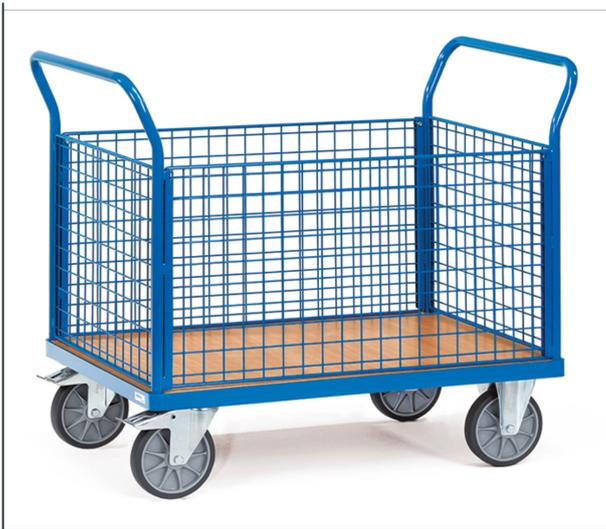
Vierwandwagen aus Stahlrohr und Profilstahl geschweißt, pulverbeschichtet blau RAL 5007. Plattform Holzwerkstoffplatte, Oberfläche Buchendekor. 2 Stirnwände und 2 Längswände aus Drahtgitter 50 x 50 x 4 mm, Wände 500 mm hoch. Eine Längswand zum leichteren be- und entladen herausnehmbar. 2 Lenk- und 2 Bockrollen mit TPE-Bereifung, Naben mit Rillenkugellager. Feststeller an den Lenkrollen, gemäß der Europäischen Norm EN 1757-3 (Sicherheit von Plattformwagen).
