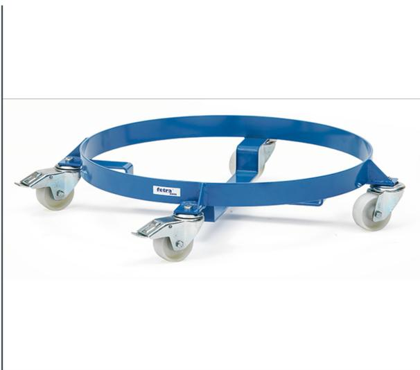
Fassroller für stehenden Transport von Stahlblech-Fässern. Geschweißte Flachstahl-Konstruktion, Kreuzstreben nach unten durchgekröpft Ø 420 mm für 60-Ltr.-Fässer, Außenring Innen-Ø 610 mm für 200-Ltr.-Fässer. Pulverbeschichtet brillantblau RAL 5007. 4 Lenkrollen, 2 Stück mit Feststeller, Räder Polyamid, Naben mit Gleitlagerung.
