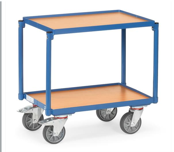
Etagen-Roller mit 2 Plattformen. Beide Rahmen mit Böden aus Holzwerkstoffplatte, Oberfläche Buchendekor, Rand 15 mm hoch. Pulverbeschichtet blau RAL 5007. Lichter Etagenabstand 400 mm. Tragkraft obere Ladefläche 100 kg. 4 Lenkrollen mit TPE-Bereifung, Naben mit Rillenkugellager. 2 Stück mit Feststeller, gemäß der Europäischen Norm EN 1757-3 (Sicherheit von Plattformwagen). Passend für Eurokästen 600 x 400 mm. Zerlegte Anlieferung.
